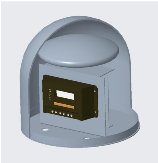
图 2 接收机内部封装示意图
