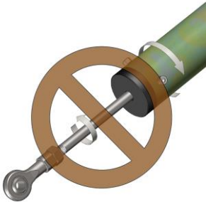
图 2-1 滑动导杆与壳体间禁止相对旋转
