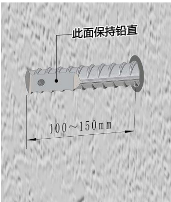
图 3-2 锚杆端部外露长度及方向
