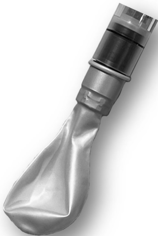
图 2-5 干燥管前端的气球
