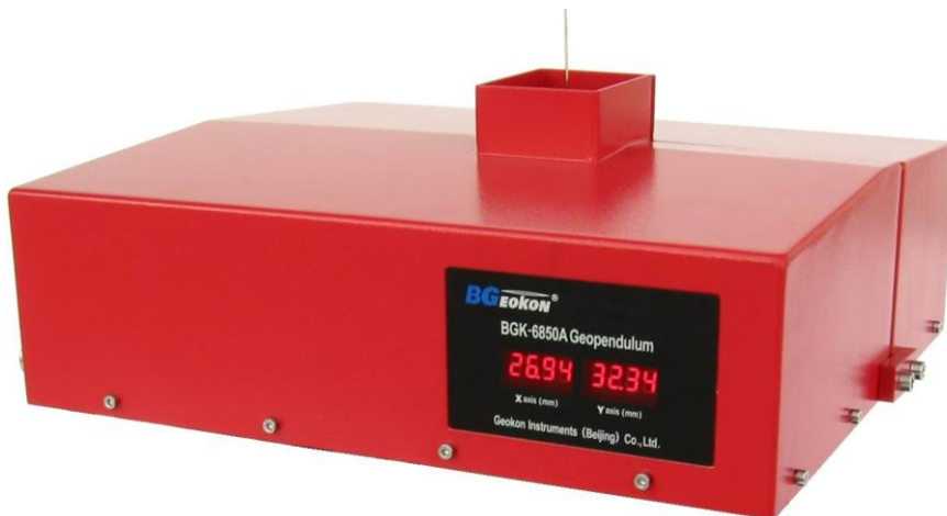
图 3 BGK-6850A 垂线坐标仪主体照片
