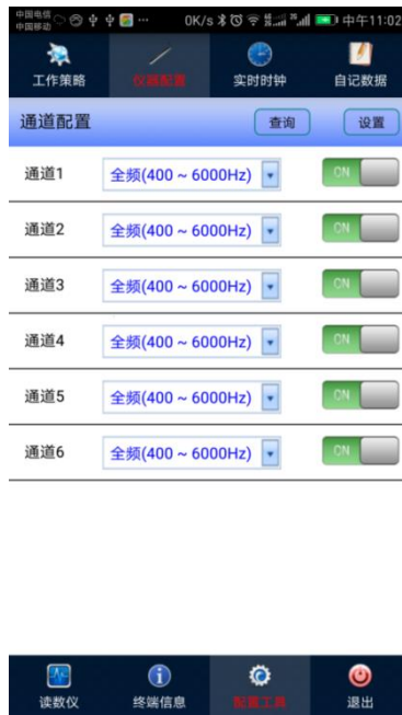
图 7 振弦传感器的频段配置
