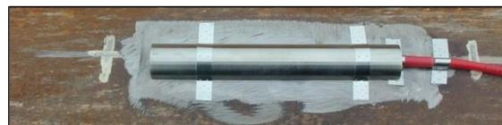
图 18 保护罩点焊固定
