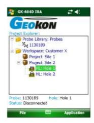
5、选择测孔,点 Application--->Live Readings,如果连接成功将自动进入数据测量,如连接不成功则进入端口设置,修改端口与前面第二步中所设端口一致,重新连接,即可进入测量。每点一下下方红点 Record Data,即可进行手动存储。(也可以在Application--->System Configuration中设置为自动读数。)一次测量完成后,传感器转 180 度,点按 Dataset1 变为 Dataset2 进行第二组数据测量。测量完毕退出测量状态,保存数据。
