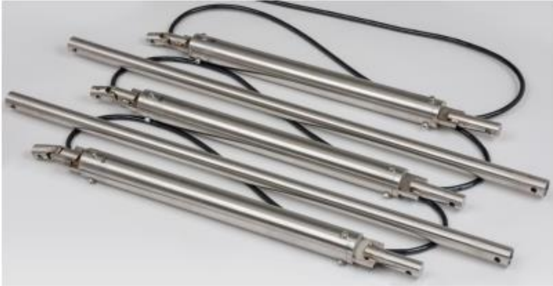
图 1 6150D MEMES 型数字可寻址测斜仪传感器组件
