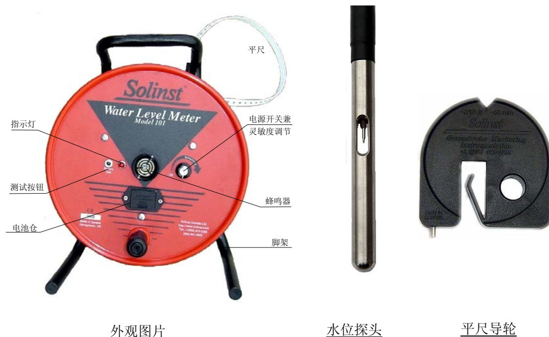
101 型平尺式水位计组成
