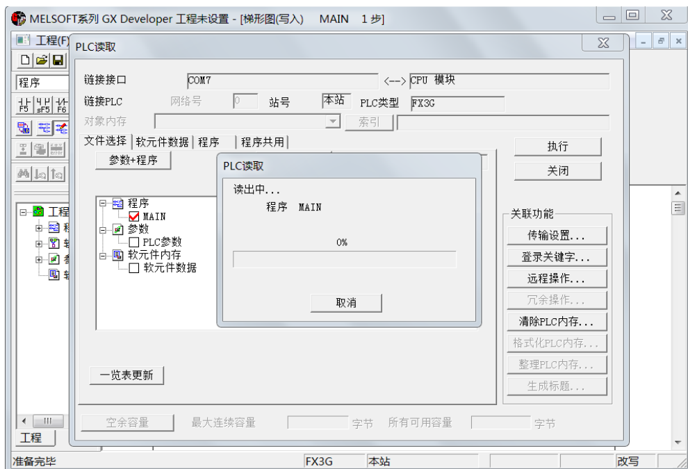
图附 8-16：读取 PLC 程序过程中
