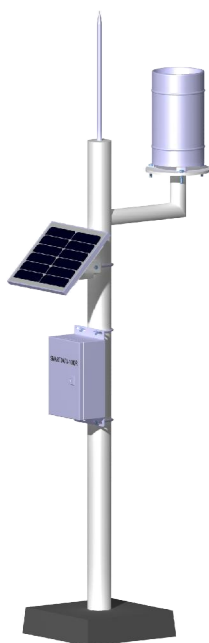
图 6.1 遥测终端机安装在立杆上
